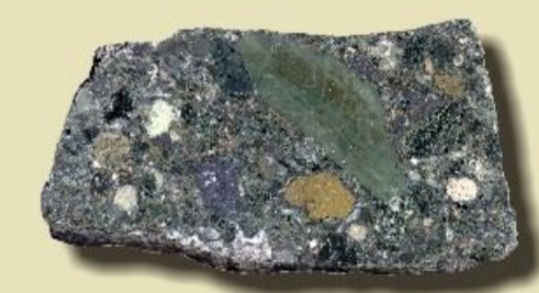
锌-铅-铜角砾岩(搬运)矿石，含块状硫化物矿石角砾(Buchans矿山)。
